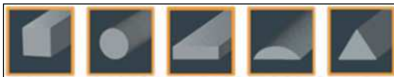
Ryc.53. Przekroje pilników do metalu
